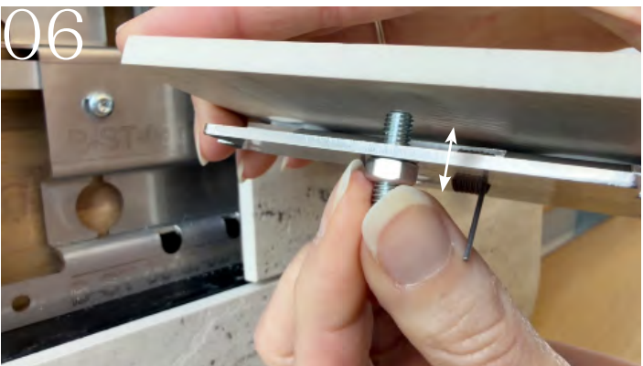
Tasten enthebeln und Schrauben auf der Rückseite zur Einstellung der Neigung entsprechend drehen.
