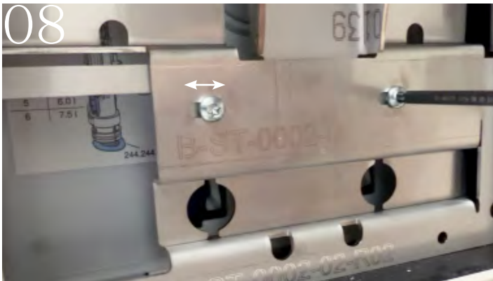
Schrauben lösen, Platte verschieben und wieder fixieren
