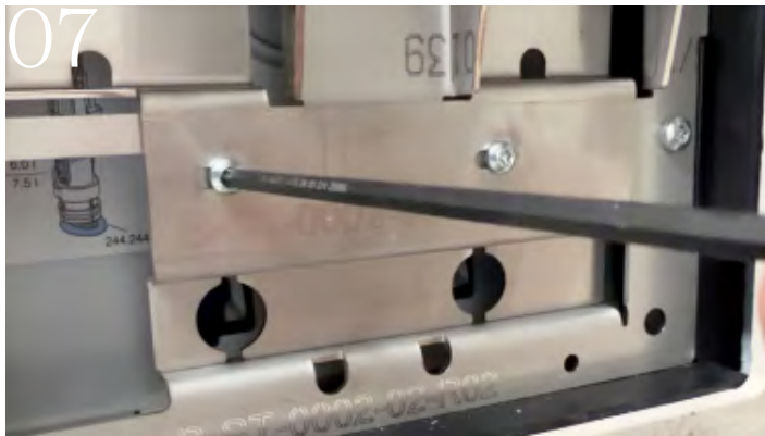
Bei Bedarf Position der Grundplatte anpassen
